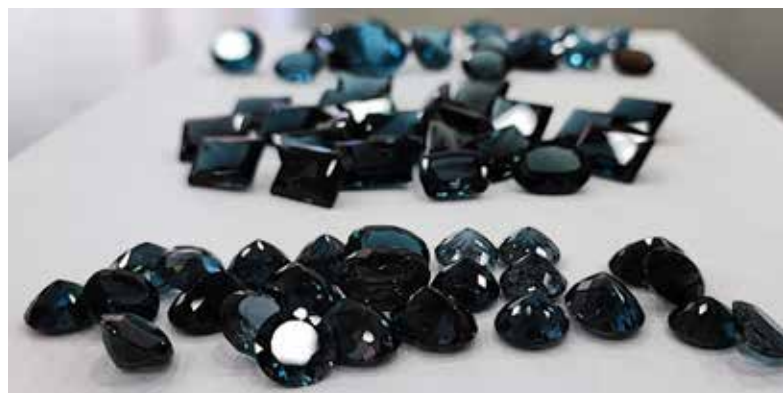
Yarim qimmatbaho topazlarning fotosurati: tabiiy rangdagi (yuqorida); reaktorda nurlantirish orqali rang berilgan (pastda);
